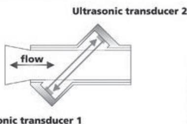
Figure 2. Ultrasonic Flow Meter
